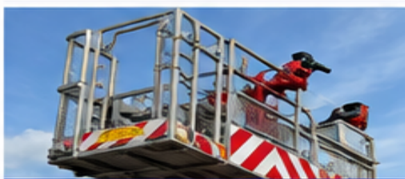
Arbeitskorb mit Wasserwerfer
