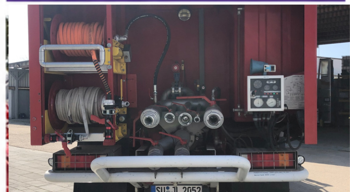
Schnellangriff mit formstabilem Schlauch / zweite Haspel
