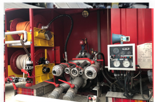
Löschwasserpumpe 1.500 l/min bei 10 Bar
